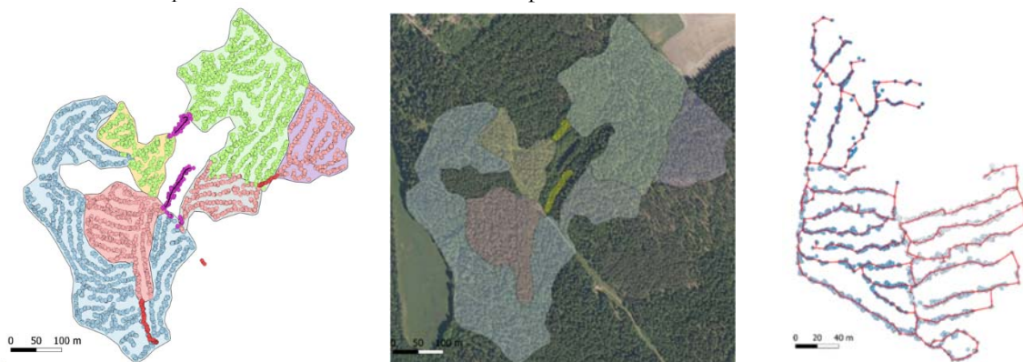
Kuva 1. Hakkuukoneen puukohtaisista sijaintitiedoista tuotetut automaattiset toimenpidekuvioiden rajaukset (vasemmalla ja keskellä), sekä automaattisesti tuotettu ajouraverkosto (oikealla). Ilmakuva © Maanmittauslaitos 2018
